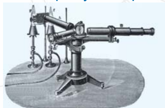
Bunsenův kahan a spektroskopická aparatura s hranolem
