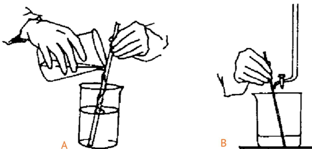
Obr. 2. Správný postup srážení: (A) přidávání činidla z kádinky; (B) přidávání činidla z byrety.
